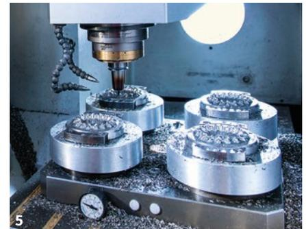
**Abb. 4 und 5** Zahnformenproduktion bei Merz Dental früher und heute (Fotos: Fa. Merz Dental).
